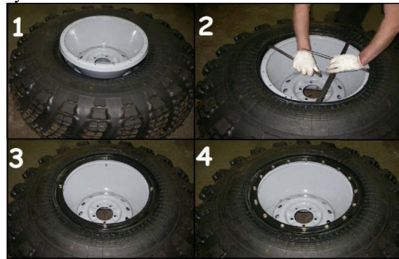
Рис. 10.4 Порядок монтажа шины ТРЭКОЛ
